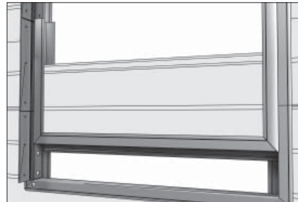
Установите нижний сегмент в проем калитки, обеспечивая зазор 5-10 мм между сегментом калитки и низом проема.
